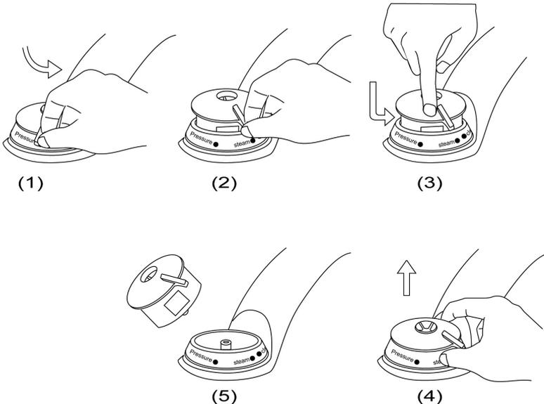
3. Tournez le couvercle à l'envers et posez-le sur une table. Retirez le dispositif anti-blocage. Avec une brosse, éliminez tous les débris alimentaires (ou autres) qui auraient pu s'accumuler dans la soupape flottante. Remplacez le dispositif anti-blocage en appuyant vers le bas.
