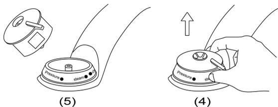
3. Déle la vuelta a la tapa y colóquela encima de una mesa. Saque la funda anti-bloqueo tirando hacia arriba. Usando un cepillo, compruebe y elimine cualquier resto de comida o de partículas extrañas que puedan estar dentro de la válvula flotante. Vuelva a poner la funda anti-bloqueo empujando hacia abajo hasta que se sujete en su posición.
