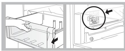
Deja reposar el frigorífico durante, al menos, 2 horas en posición vertical antes de conectarlo. Comprueba los datos de la placa de características (110-120V con toma de tierra) (1.3.1, 1.3.2).
